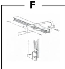
Per eseguire il taglio delle guide laterali con la massima precisione togliere dall'altezza (H) cm. 5,2 dopodiché infilare l'aggrancio registrabile nell'accostata guida dalla parte interna.
