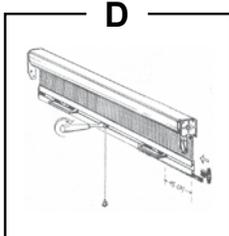
Infilare le maniglie alle estremità della barra maniglia a circa 15 cm. Inserire il cordino al centro e per fissarlo girare in senso orario con il cacciavite. Mettere i tappi di contenimento.
