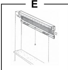
Per il montaggio del cassettono praticare due fori Ø 6 in corrispondenza a quelli già predisposti sulle testate. Non svitare completamente per permettere l'inserimento successivo delle guide. Stringere le viti ad operazione avvenuta.
